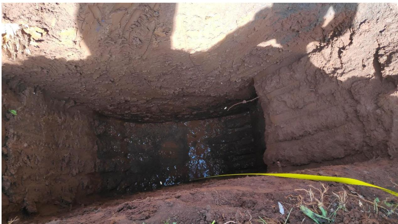
**FOTO 04 – Surgência de água na trincheira executada no terreno em estudo**
