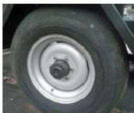
Pneus estão sendo deteriorados pela ação do tempo
